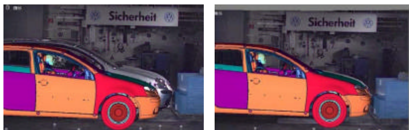
Auswirkungen der Kameraabbildungsfehler: links unkorrigiert, rechts korrigiert (Bilder von Volkswagen AG, Forschung und Entwicklung, Abt. EZTV-CE)
