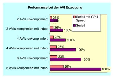
Erzeugung jeweils eines AVIs mit 301 Einzelbildern, in der Auflösung 1280 x 1024 mit Bildaufbereitung (Weißabgleich, Farbmatrix, Gamma, Sättigung und Schärfen)
